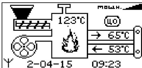
автоматического горения и на дисплее отображается основной экран котла.
