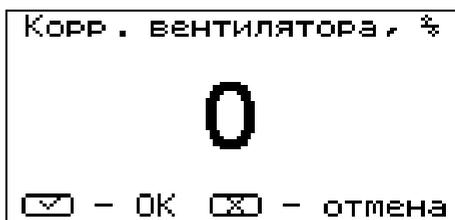
7.5.8. Для настройки работы вытяжного вентилятора, в случае его использования для удаления дымовых газов при недостаточном разрежении за котлом, выберите пункт меню "Вытяжной вентилятор". Пункт меню предназначен для выбора режимов работы вытяжного вентилятора и установки скорости его вращения.
