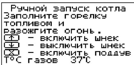
котел перейдет в режим поддержания горения (▲). В этом режиме привод шнека будет периодически включаться, при условии снижения температуры газов, а вентилятор отключается.
